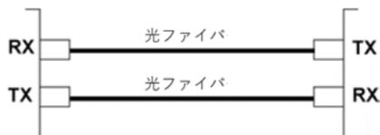
光ファイバケーブルの両端で、Rx-to-Txの接続ルールが守られていることを確認してください。
